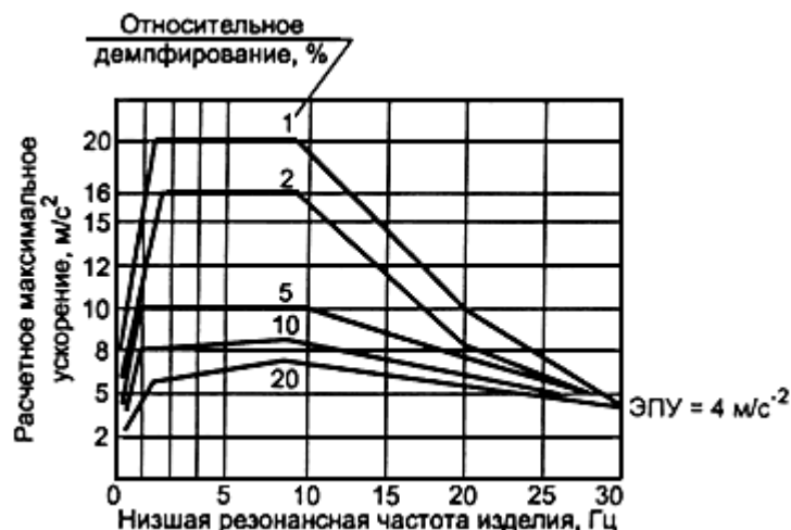
Рисунок - Обобщённые спектры ответа для горизонтального направления 9 при нулевой отметке
