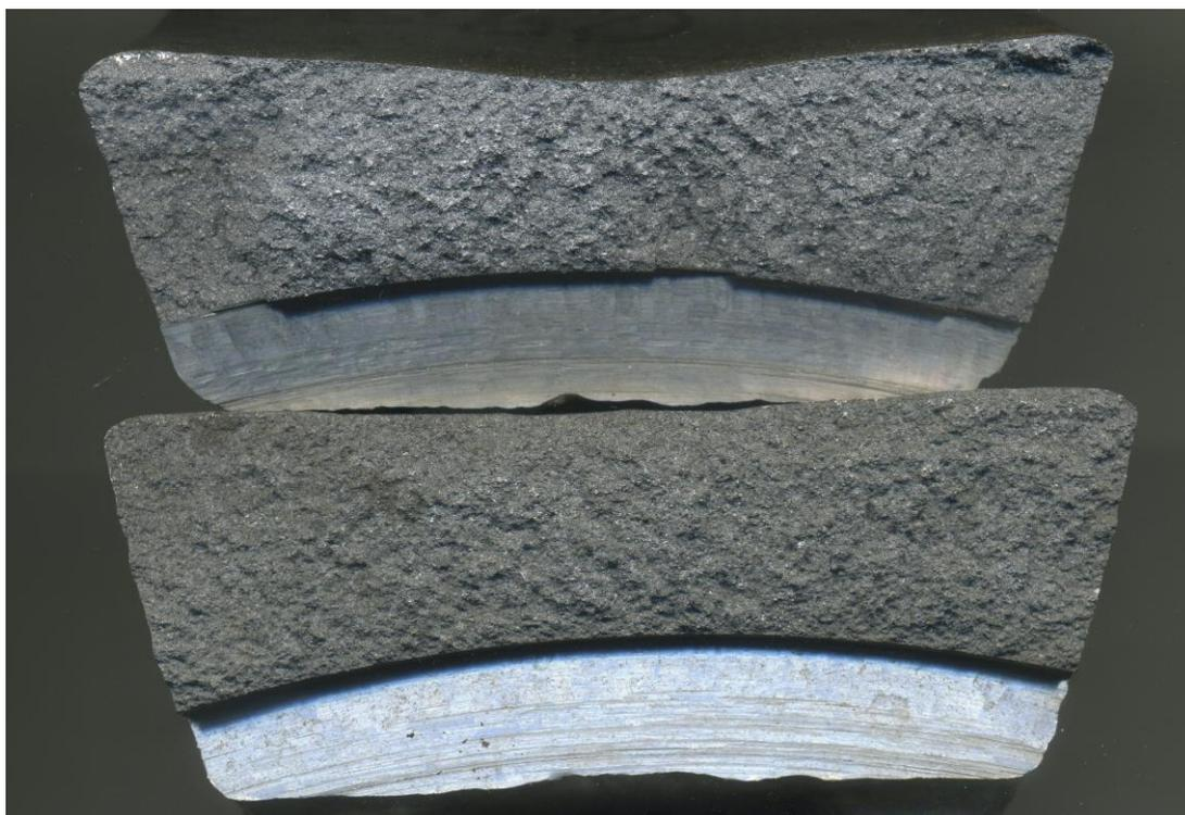
Рисунок Е.1 – Окисные пленки в изломе чушки. Сплав АК8М3
