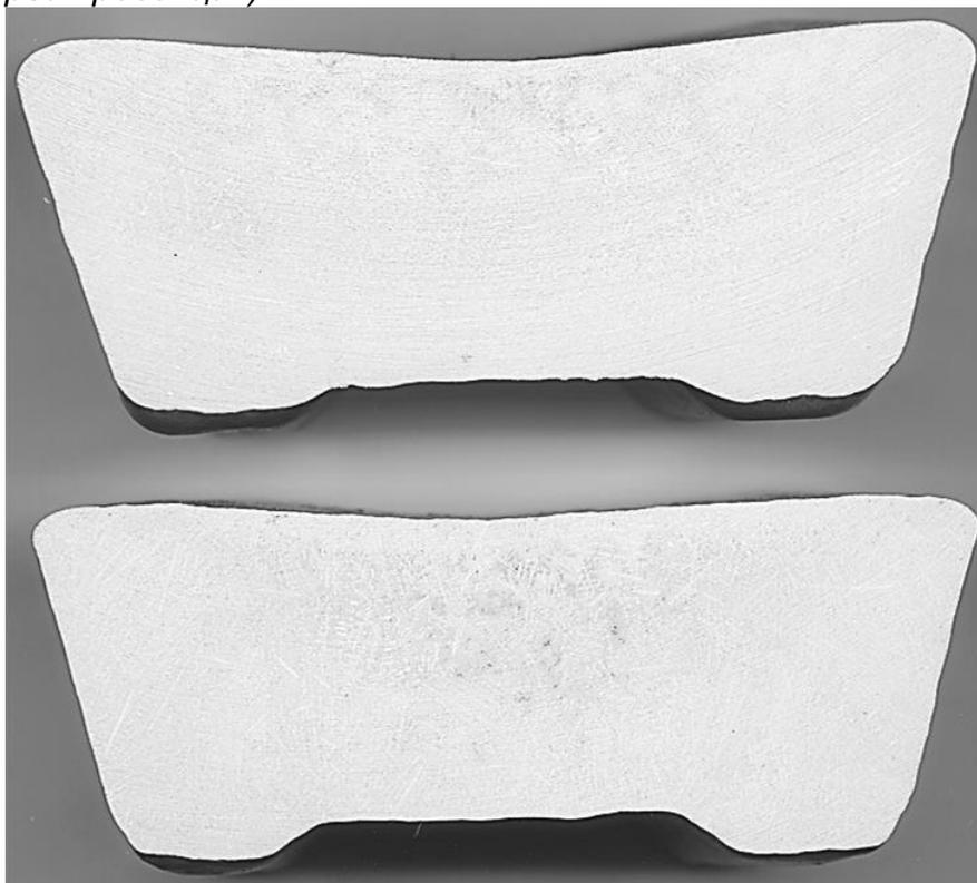
Рисунок А.1 – Изображения темплетов согласно балльной шкале оценки газовой пористости (1 Балл)
