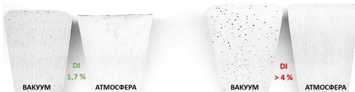
Рисунок А.7 – Пример сравнения поверхности образцов, полученных после кристаллизации под низким давлением и в атмосфере
