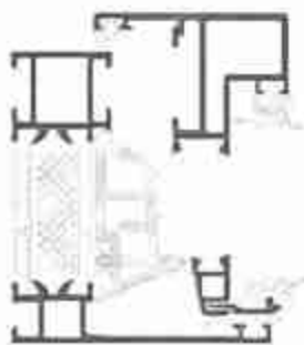
в) Комбинированные профили с многокамерной термоизоляционной вставкой
