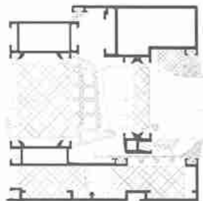
д) Комбинированные профили с термоизоляционной вставкой и полостями, заполненными пенным утеплителем
