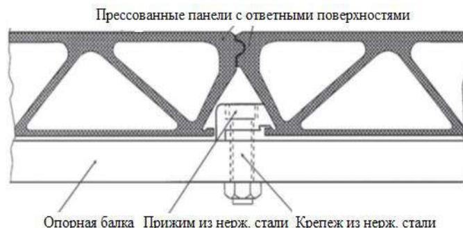
Рисунок 14.3. Соединение прессованных профилей в сборной ортотропной плите.
